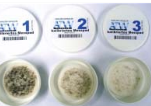
Messpads nach der Messung an einer Oberfläche mit 14 g/m 2 Ablagerungen. Deutlich ist die Verschmutzung der Messpads zu sehen.
