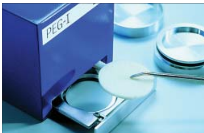
Messgerät PEG-1 zur Bestimmung der Staubflächendichte nach Rotationsverfahren.
